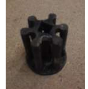
Ritzel Walzenachse gesprengt -> MIG-geschweisst 25.01.2018
